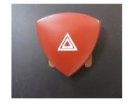
Remarque: Un conducteur a besoin de près d'une seconde pour allumer les feux de détresse manuellement. Cela correspond à une distance de freinage pour sa voiture et celle qui suit de 16 mètres à 60 km/h et 60 mètres à 130 km/h. Les feux de détresse se mettent en fonction automatiquement en cas de forte décélération. Ils permettent ainsi au conducteur de rester concentré sur la route et de garder le contrôle du véhicule.
