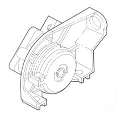
Au démarrage du moteur, l'ouverture du papillon est programmée à une certaine position dans le cas où la volonté conducteur est inférieure à ce seuil.
